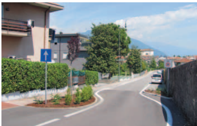
Figura 8 - Interventi di moderazione del traffico (chicane)
