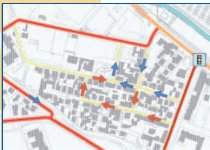
Pero (MI), frazione di Cerchiarelo. Esempio di 'labirinto circolatorio' progettato per evitare l'uso della viabilità interna per 'saltare' il semaforo.
