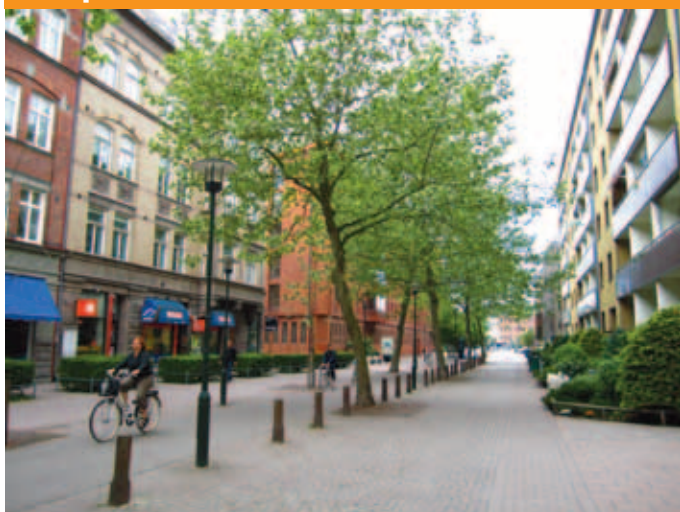
Kaptensgatan - Malmö (S) - Esempio di strada veicolare convertita in strada residenziale; è rimasta la delimitazione delle sede pedonale, mentre nella ex sede carrabile, ora ciclo-pedonale, sono stati inseriti lampioni, alberature e panchine.
