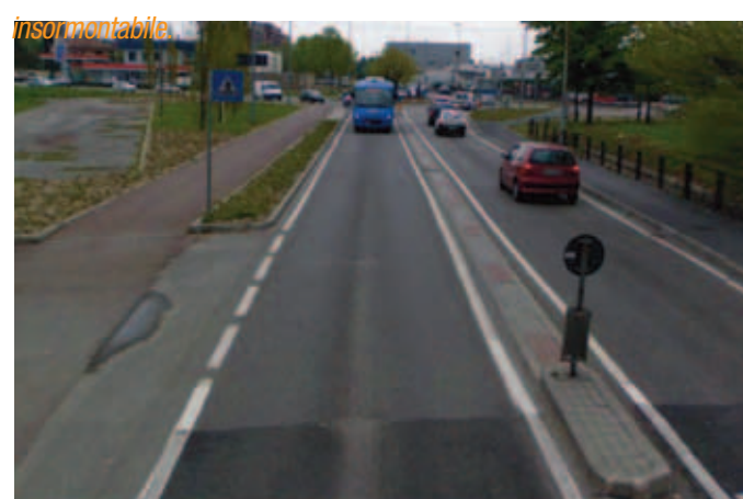
Settimo Milanese, via per Vighignolo. Il progetto realizzato nel tratto più a sud alla fine degli anni '90 sceglie la tipologia della fascia semisormontabile, dimostrando di avere una efficacia maggiore e minori controindicazioni del progetto precedente (oltre a costi inferiori)
