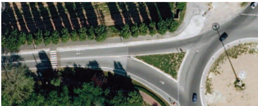
Opera (MI), via Marcora. L'attraversamento è inspiegabilmente arretrato in un luogo che, oltre ad imporre deviazioni inaccettabili, non offre alcuna protezione.
