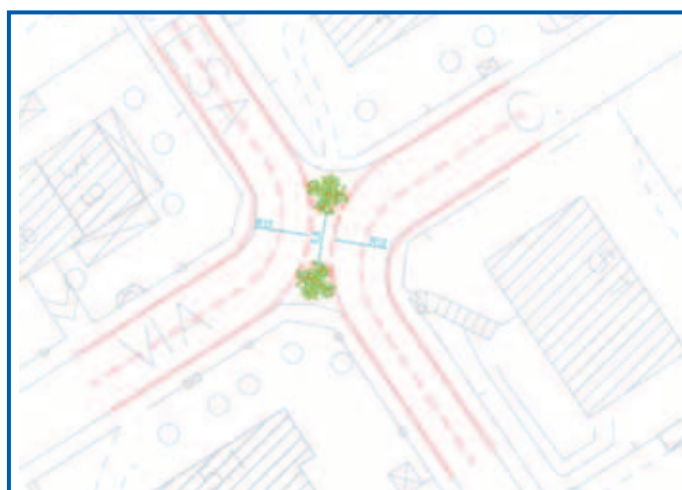
Schema di realizzazione di taglio diagonale dell'intersezione
