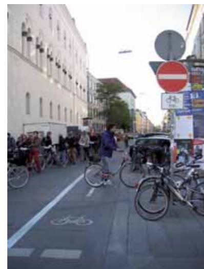
Foto 02 Strada a senso unico "eccetto biciclette" con corsia riservata (Germania).
